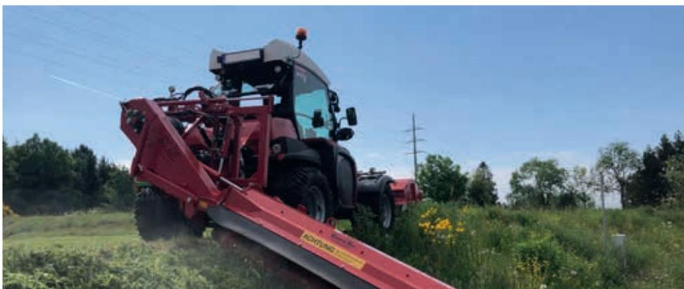
Für Kommunen und Betreiber von Freizeitgeländen besticht der Grip4/70 durch seine Einfachheit, Robustheit und den geringen Platzbedarf. Ausgestattet mit einer breiten Rasenbereifung wird der Bodendruck so stark reduziert, dass ein befahren von Rasenflächen problemlos möglich ist. Dank der Allradlenkung ist ein problemloses und enges umfahren von Hindernissen möglich.
