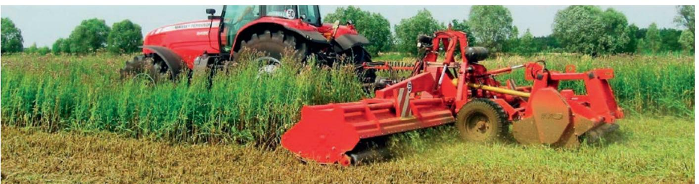
Gezogene Ausführung komplett auf Fahrwerk aufgebaut mit Deichsel
