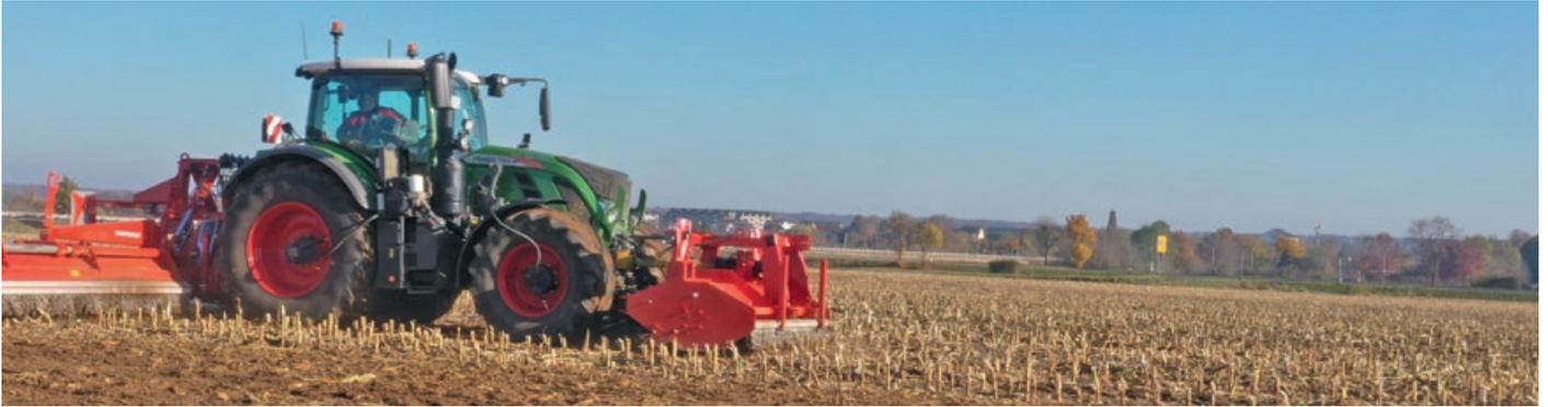
Aufgelöste Version: seitliche Mulchköpfe im Heckanbau und Mittelmaschine im Frontanbau
