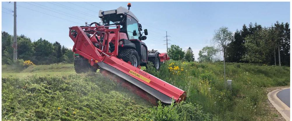
Für Kommunen und Betreiber von Freizeitgeländen besticht der Grip4/70 durch seine Einfachheit, Robustheit und den geringen Platzbedarf. Ausgestattet mit einer breiten Rasenbereifung wird der Bodendruck so stark reduziert, dass ein befahren von Rasenflächen problemlos möglich ist. Dank der Allradlenkung ist ein problemloses und enges umfahren von Hindernissen möglich.
