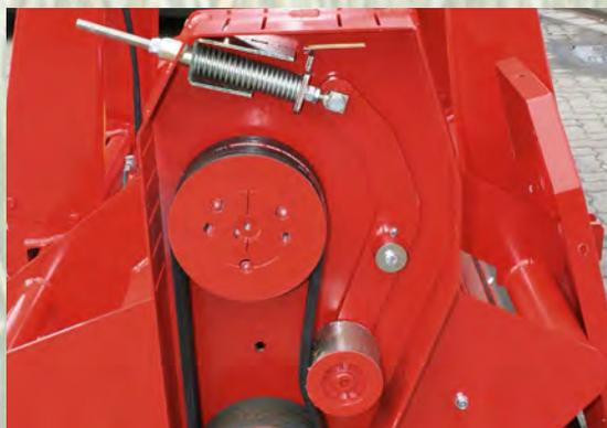
Verstärkter Riemenantrieb mit automatischer Keilriemenspannvorrichtung
