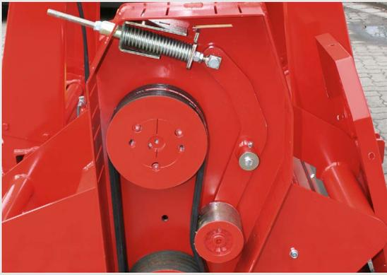
Verstärkter Riemenantrieb mit automatischer Keilriemenspannvorrichtung
