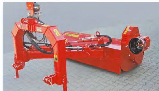
Version GA = Getriebe außenliegend
