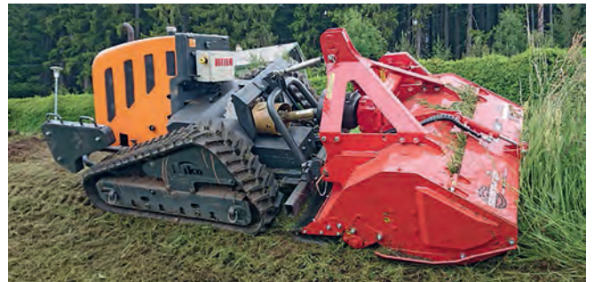
TANGO 1300 an einem Raupen-Mähroboter
