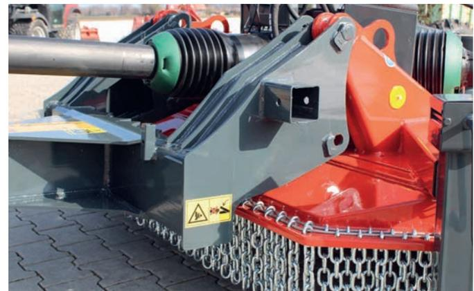
Die Deichsel kann je nach Wunsch oberhalb oder unterhalb der Gelenkwelle montiert werden (Serie). - Abbildung: Deichsel unten
