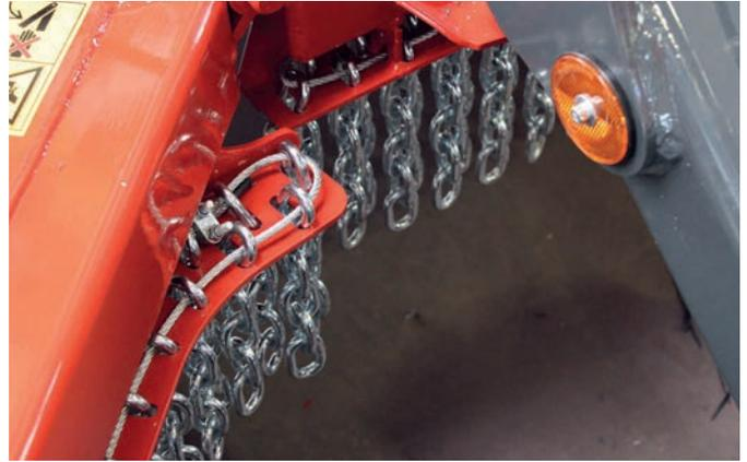
Die Verteilung des zerkleinerten Materials ist entscheidend: das Design der Kettenvorhänge trägt dazu bei. (Serie)
