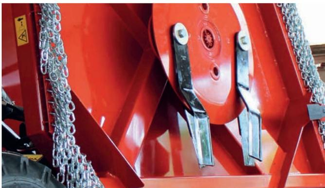
Der große Abstand zwischen Messer und der Rahmenkonstruktion sorgt für ein leichtgängiges Arbeiten mit bester Zerkleinerungsqualität (Serie).
