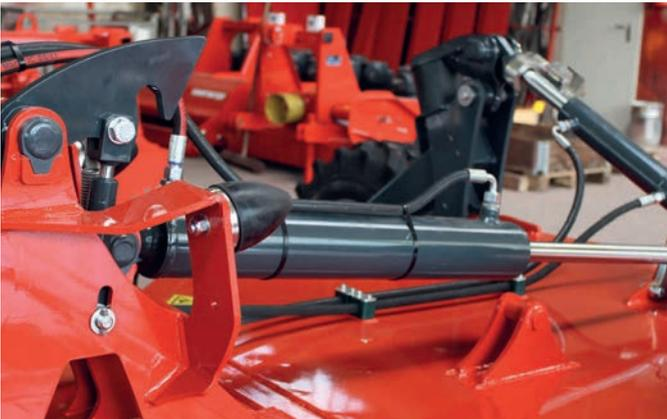
Innovatives automatisches Verriegelungs- und hydraulisches Entriegelungssystem. (Serie)
