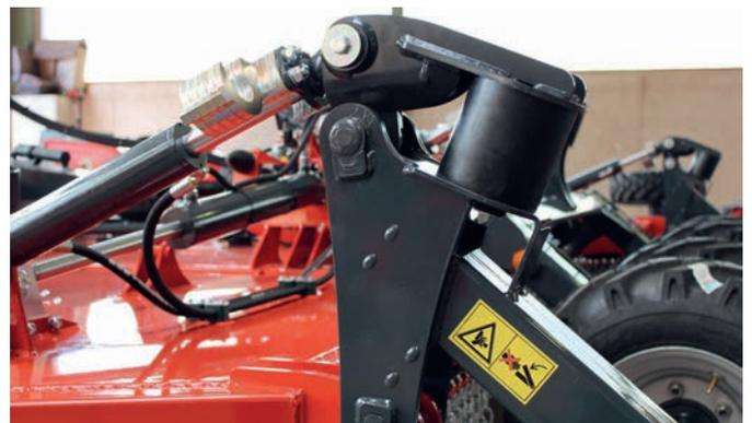
Die Dämpfung über Gummipuffer an jeder Achse und ein angepasster Reifendruck sorgen für hohen Arbeitskomfort (Serie).
