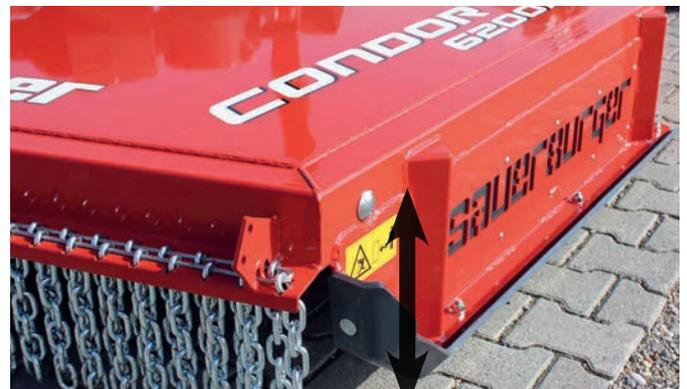
Höhe des Mulchdecks 33 cm für das Zerkleinern von großen Mulchmassen. Doppelter Kettenvorhang, vorne und hinten (Serie).
