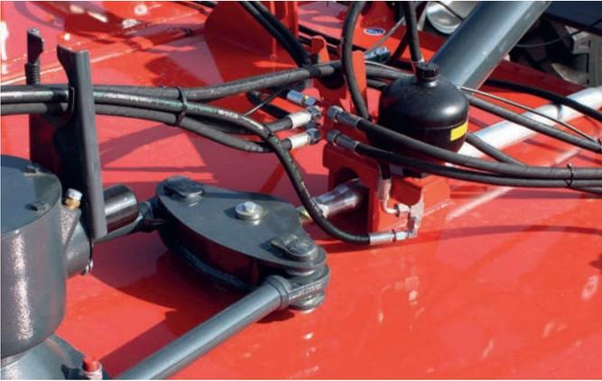
Die Neigungseinstellung wird über die Längenveränderung der Zugstange vorgenommen. Sie verbindet das Fahrwerk und die Deichsel (Serie).
