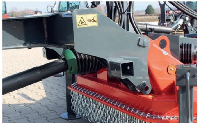
Die Deichsel kann je nach Wunsch oberhalb oder unterhalb der Gelenkwelle montiert werden (Serie). - Abbildung: Deichsel oben
