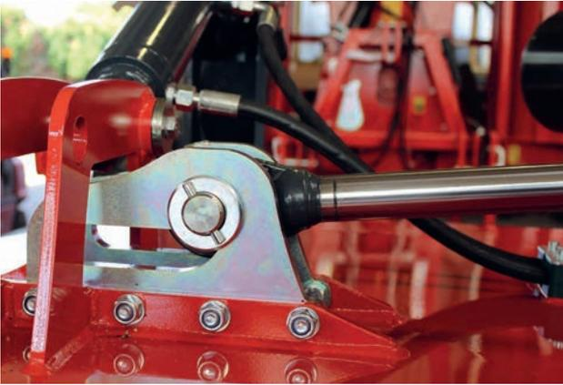
Das Flügelklappsystem ist so konzipiert, dass es freie Bewegungen und eine risikofreie Boden Anpassung gewährleistet. (Serie)
