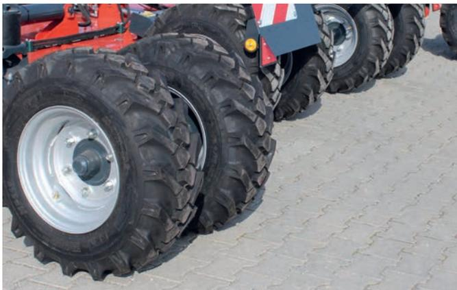
Verschiedene Profilvarianten der Reifengröße 10.0/75-15.3 stehen zur Verfügung: BKT AW702 (10PR) oder MP567 (18PR) - Abbildung: MP567
