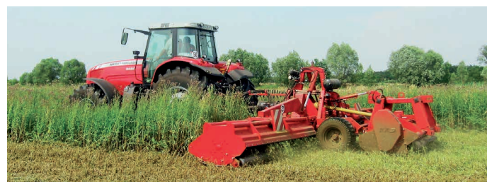
Gezogene Ausführung komplett auf Fahrwerk aufgebaut mit Deichsel
