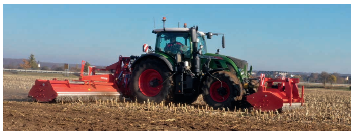
Aufgelöste Version: seitliche Mulchköpfe im Heckanbau und Mittelmaschine im Frontanbau
