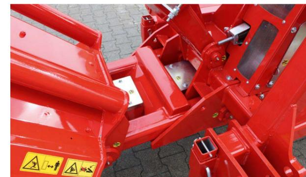
Die H-Schwinge überträgt die am Mulchkopf entstehenden Vorschubkräfte auf den Dreipunkttragrahmen und ermöglicht es dem Mulcher, den Konturen des Bodens frei zu folgen.
