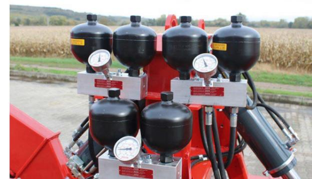
Die Entlastungsvorrichtung ermöglicht es, den Bodendruck der Mulchelemente hydraulisch anzupassen.
