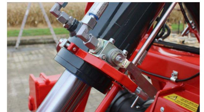
bei aktivierter Hubbegrenzung werden die Mulchköpfe auf das voreingestellte Maß angehoben, wodurch ein unbeabsichtigtes Einfahren der Mulchköpfe verhindert wird.
