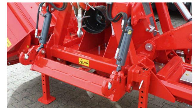
Die Mittelmaschine kann optional von einer hydraulischen Hitch aufgenommen werden, das ist besonders im Betrieb in der Rückfahreinrichtung zu empfehlen.
