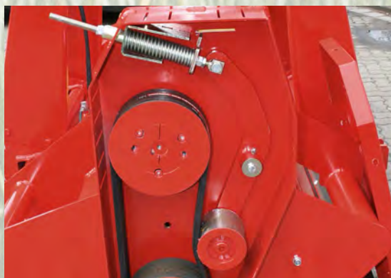
Verstärkter Riemenantrieb mit automatischer Keilriemenspannvorrichtung
