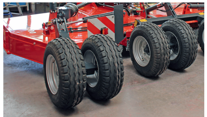
Verschiedene Profilvarianten der Reifengröße 10.0/75-15.3 stehen zur Verfügung; BKT AW702 (10PR) oder MP567 (18PR)
