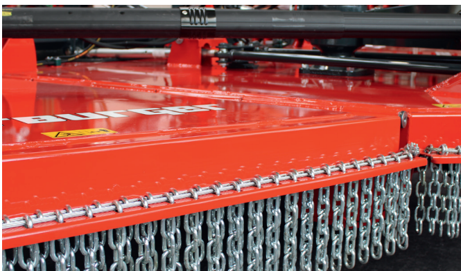
Glattes Deck um Schmutzansammlungen zu verhindern und zum einfachen Reinigen. Doppelter Kettenvorhang, vorne und hinten (Serie).
