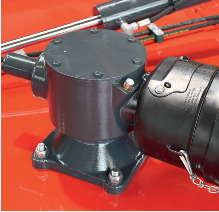
Rotorgetriebe 180 PS max. Leistung - Ölvolumen: 3,5 Liter.
