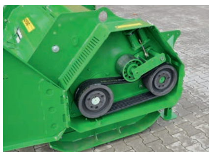
seitlicher Keilriemenantrieb mit automatischer Keilriemenspannvorrichtung
