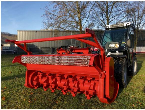
Hydraulisch aufstellbare Einlaufklappe
