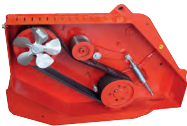
Auf Keilriemenscheibe montierter Ventilatorenflügel zur besseren Wärmeabfuhr im Keilriemenantrieb
