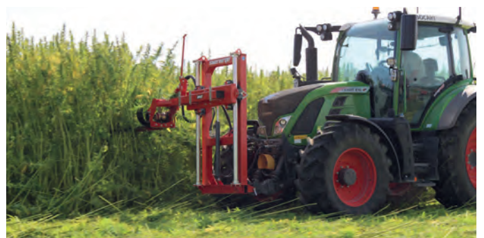
Im Einsatz ein Hanfscneiderwerk DMS-2750 mit einem Hubmast.
