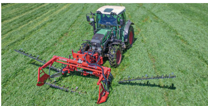
Frontschmetterlinge sind in den Arbeitsbreiten 7,3 m bis 10,0 m erhältlich.
